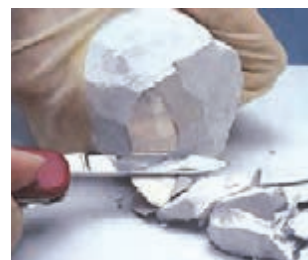
شکل ۵- الف) جلائی نقره ای فلز سدیم در مجاورت هوا به سرعت از بین می رود و سطح آن کدر می شود.
