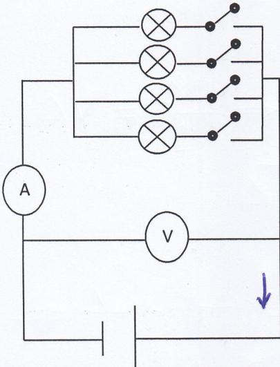
۸- در شکل مقابل تعدادی لامپ مشابه به طور موازی به هم متصل شده اند و هر لامپ با کلیدی همراه است. بررسی کنید که با بستن کلید ها یکی پس از دیگری عدد هایی که آمپر سنج و ولت سنج نشان میدهد چه تغییری میکند؟ چرا؟ ۱ نمره
