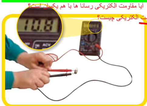
شکل ۸- اندازه‌گیری مقاومت لامپ خاموش با اهم سنج دو سر سیم را به دو طرف لامپ متصل می‌کنیم
