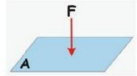
$$p = \frac{F}{A} \quad \text{یا} \quad \text{فشار} = \frac{\text{نیرو}}{\text{سطح}} \quad (1)$$
