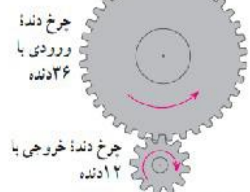
شکل ۱۶- به ازای هر بار چرخش چرخ دنده بزرگ چرخ دنده کوچک سه بار می چرخد.
