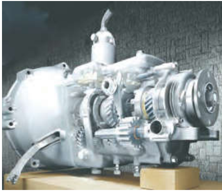
شکل ۱۵ - ترکیب پیچیده‌ای از چرخ دنده در جعبه دنده خودرو
